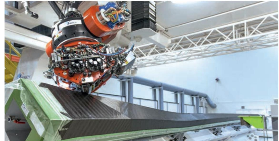
Выкладка лонжерона консоли крыла на автоматической порталной установке
